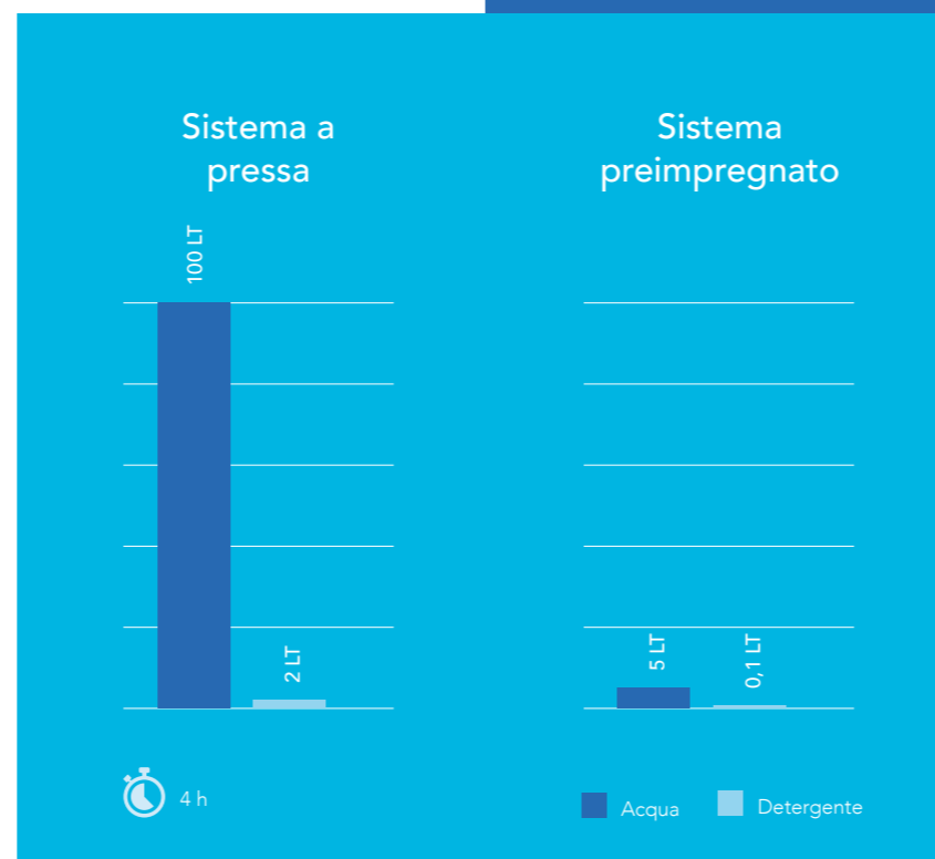
Fig. 12 Consumo orario di acqua e di detergente nel sistema tradizionale a pressa e nel sistema preimpregnato Markas System.
